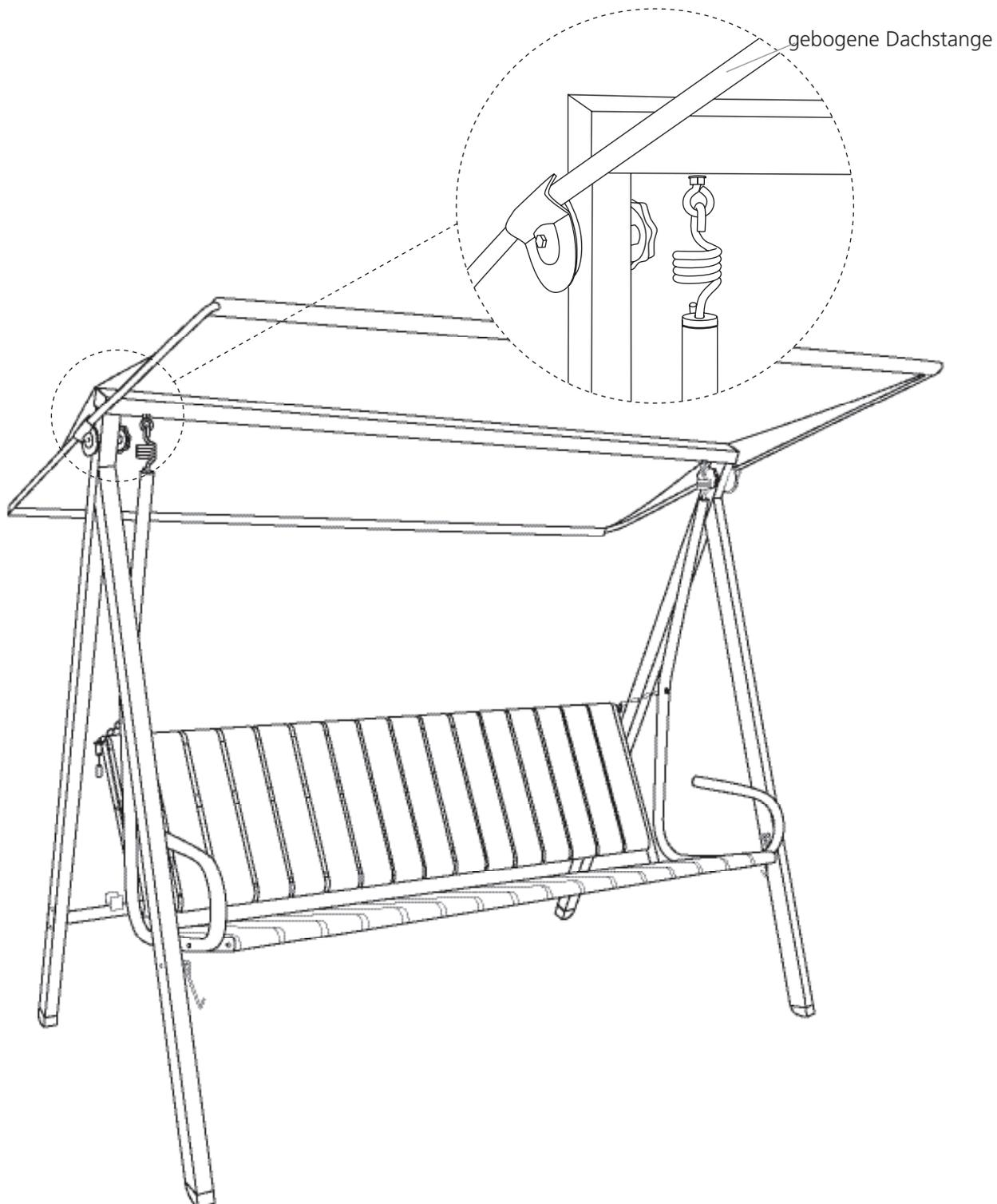
Abdeckkappen für Muttern anbringen und Bohrung der Hängerohre abdecken
