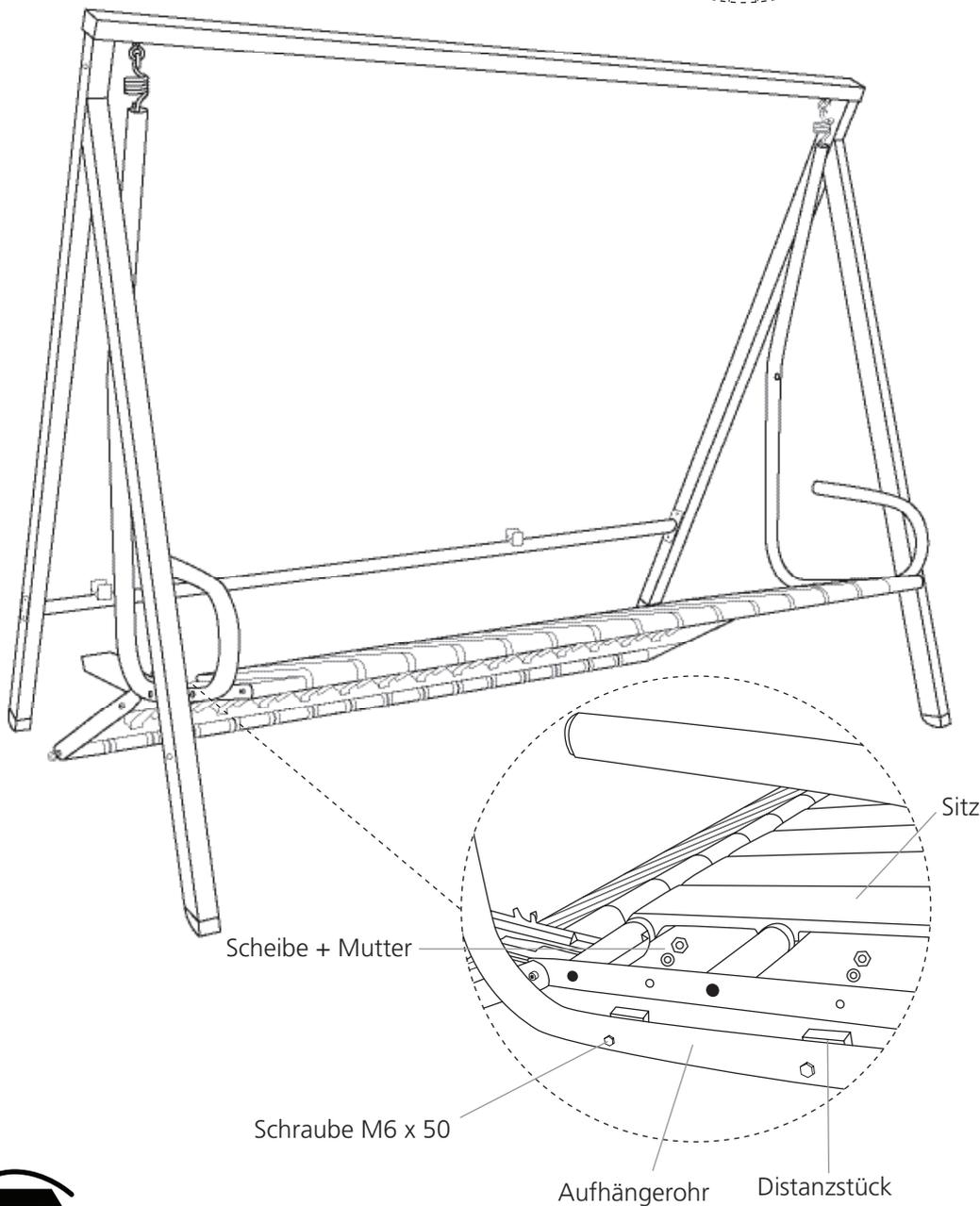
Lehne einhängen und Feststellhaken montieren
