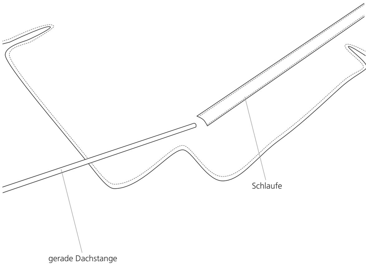
gerade Dachstangen in die gebogenen Dachstangen einschieben
